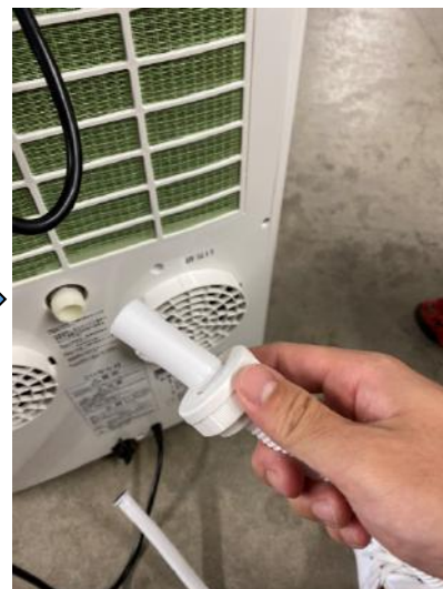
ゴム栓カバーを排水ホースに通す
