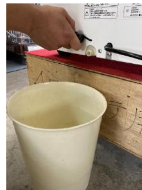
排水ドレン栓を外す
