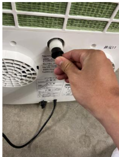
ゴム栓を外す ※ゴム栓は無くさないように保管しておいて下さい
